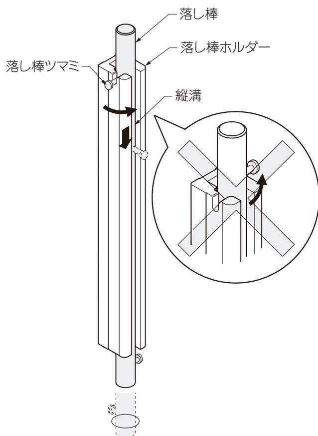
①落とし棒ツマミを縦溝の位置まで回転し、縦溝に沿って落とし棒を下げます。
