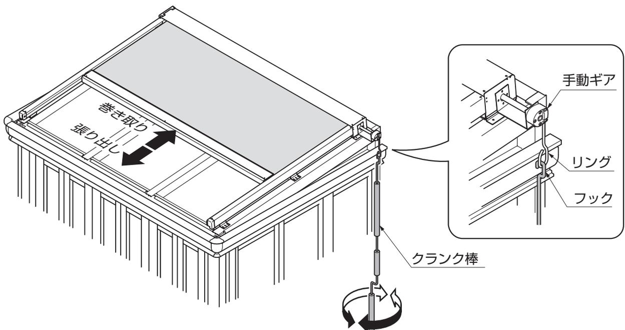
①クランク棒のフックを手動ギアのリングに引っ掛け、手回しで「巻き取り」「張り出し」を行ないます。
