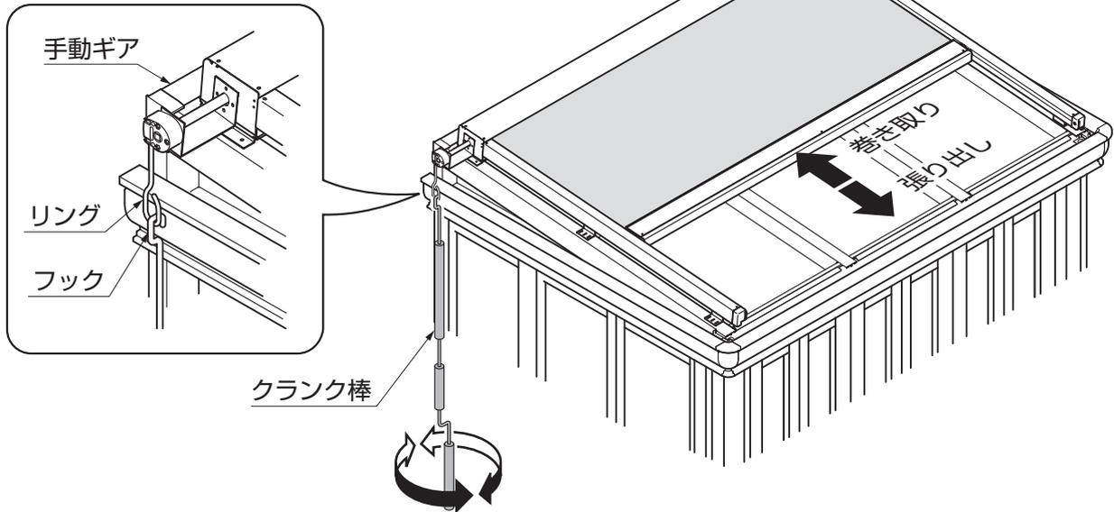
①クランク棒のフックを手動ギアのリングに引っ掛け、手回しで「巻き取り」「張り出し」を行ないます。
