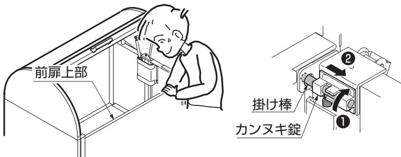
①前扉を開けるときは、前扉の上部を手で持ちながら、もう片方の手でダストック左右のカンヌキ錠の掛け棒を外して下さい。
