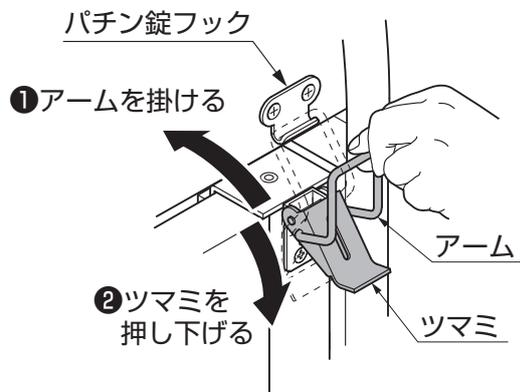
④パチン錠のアームをパチン錠フックに掛けて、ツマミを下に押し下げるとパチン錠が掛かります。
