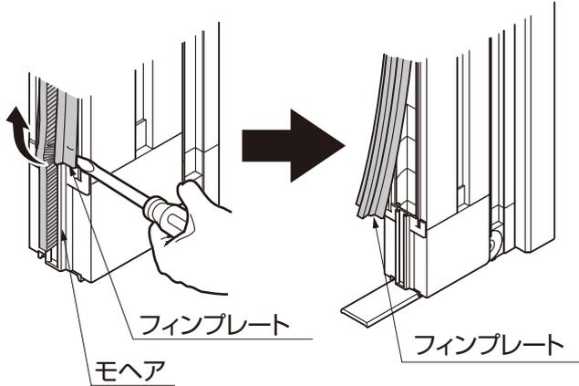
①スライドバーの建付け調整ネジは、スライドバーの内側にあります。フィンプレートを図のようにはずしてください。
