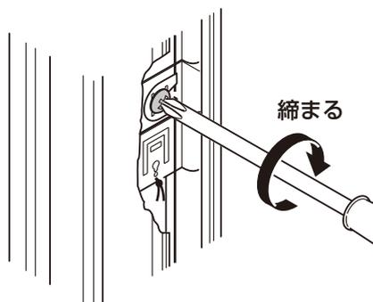
④白キャタピラの調整ネジを締め付け固定します。
