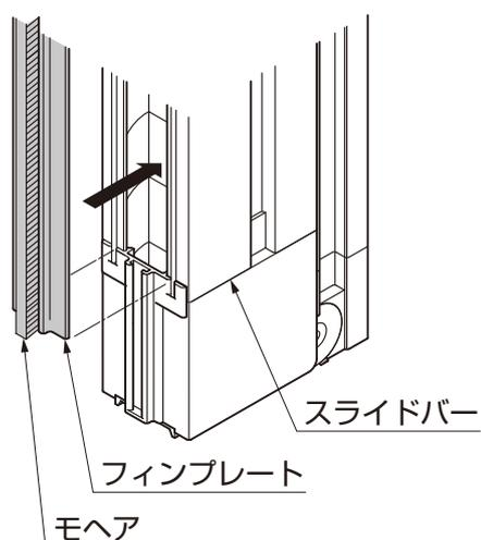
①フィンプレートとモヘアの先端を合わせ、スライドバー下部の溝に合わせて押付け、取付けます。
