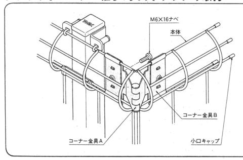
フェンスを途中で切断した 時、切断面に小口キャップを 取付けます。
