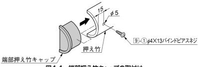
図4-4 端部押え竹キャップの取付け
