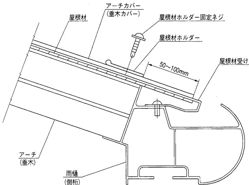
●屋根材ホルダーを屋根材の端部から50~100mmの位置に、各アーチ(垂木)中心にM4×19ピース各一本で取付けます。この時、アーチ(垂木)およびアーチカバー(垂木カバー)に下穴は不要です。
