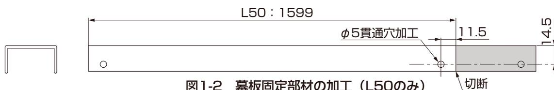
図1-2 幕板固定部材の加工 (L50のみ)
