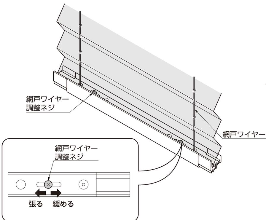
① 網戸枠固定側の網戸ワイヤー調整ネジを緩めて、ワイヤーの張りを調整してください。
