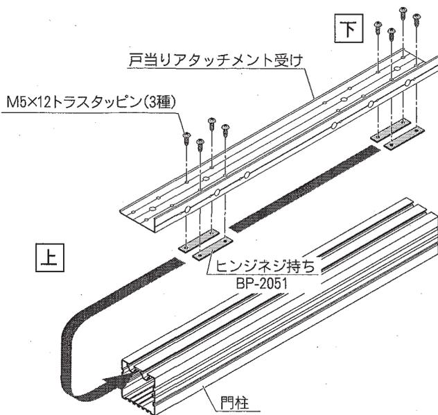
⚠ 左右勝手に、戸当りアタッチメント受けの取付ける向きが変わります。左のイラストは「右勝手の場合」を示しています。「左勝手の場合」は左右対称になります。詳しくはヒンジセット内の施工説明書 [ME-2135] ③ 戸当り部材の取付けを参照してください。
