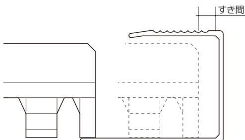
③連結は雄部（凸部）と雌部（凹部）を同一方向に並べ、雄部に雌部を重ね合わせて下方向に「パッチン」と音がするまで押込んでください。
