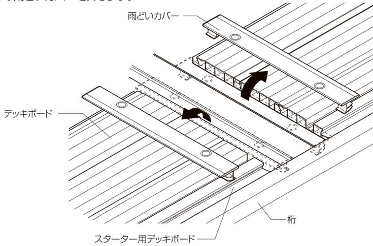
②バルコニーの連結部材で段差が発生するため、不陸調整を行ってください。(B-4参照)
