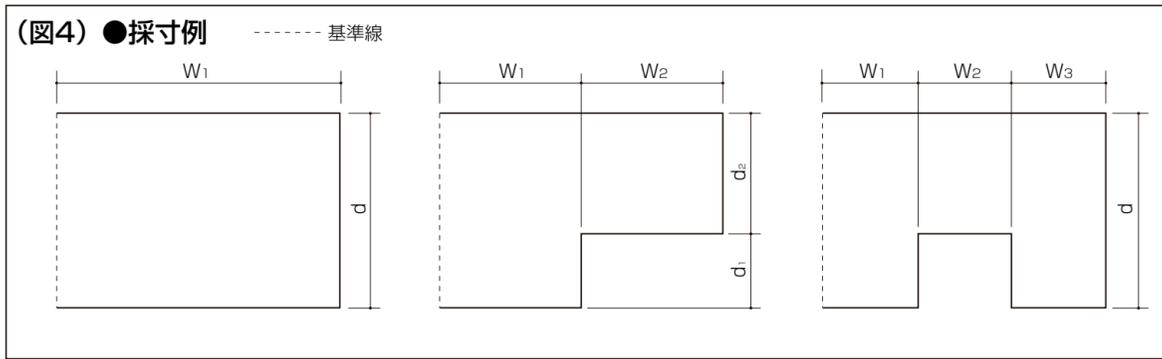
②雨戸戸袋、物干し、柱、排水溝などの障害物について、位置の確認と寸法測定を行ってください。
