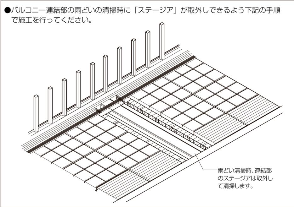
①連結部の雨どいカバーを外します。
