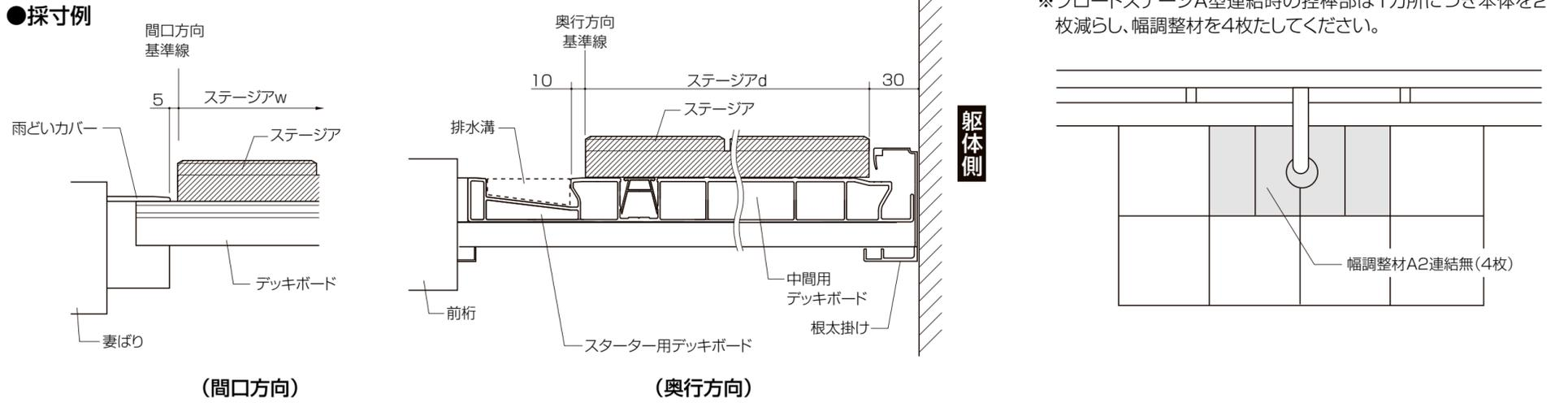
※ブロードステージA型連結時の控棒部は1カ所につき本体を2枚減らし、幅調整材を4枚たしてください。
