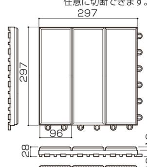
※切断の場合、枠体裏面より木ねじ M2.7×16(現場手配)で必ず止めてください。
