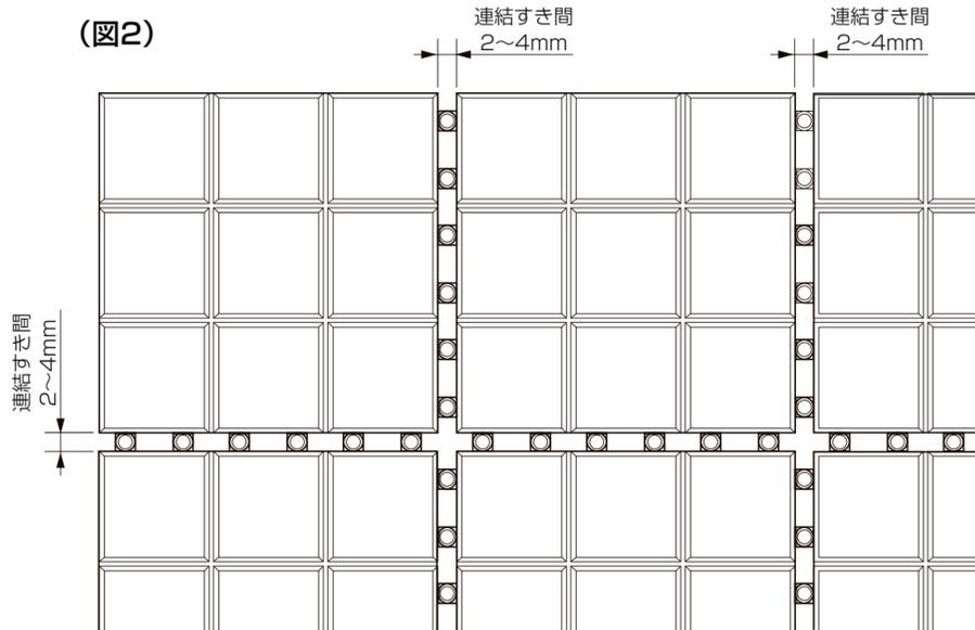
※冬場（気温10℃以下）は連結すき間を完全に（4mm）開けてください。その他の季節（気温10℃以上）は連結すき間を2mm開けてください。
