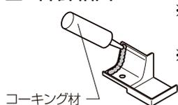
※笠木カバーとの接触面にシーリングをしてから取付けてください。
