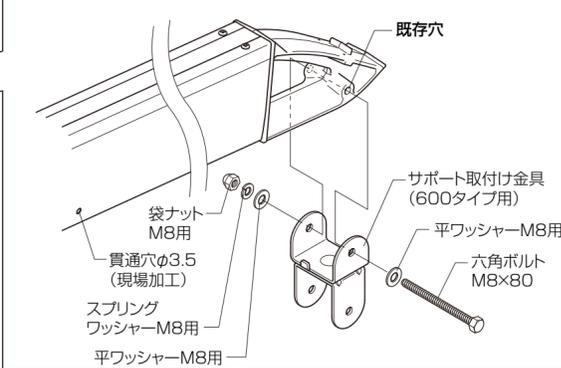
■サポートA取付け方向(A部詳細図)
