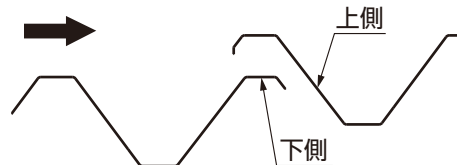
図4-6 折板重なり部詳細図
