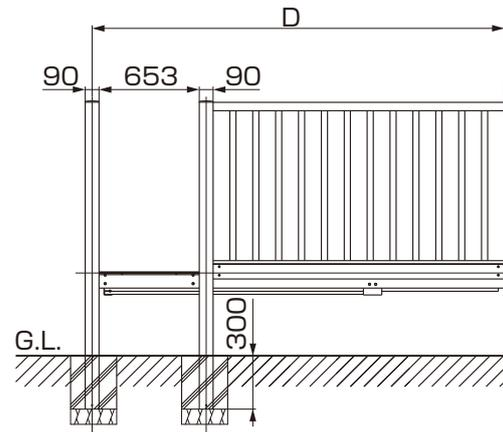
図3-6 開口タイプ側面図 (9尺)
