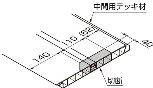
●柱と干渉する部分を切断してください。
