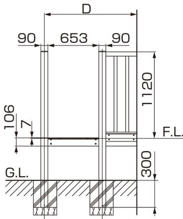
図3-5 開口タイプ側面図 (4~6尺)
