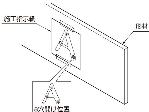
①形材に施工指示紙を仮止めし、 $\phi 3.5$ の下穴を開けてください。
