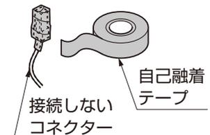
●接続しないコネクターがある場合は、必ずコネクター結線部を自己融着テープなどで防水処理をしてください。故障・感電の原因になります。
