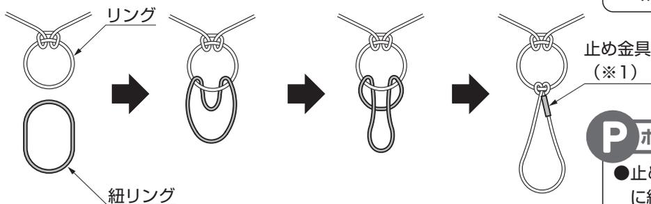
図1-8 紐リングの取付け方
