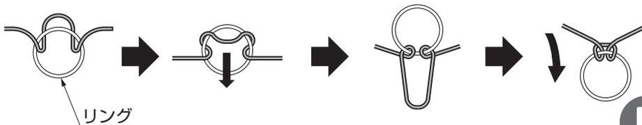
図1-7 リングの取付け方
