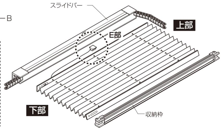
② スライドバーにセットテープを取付けます。セットテープ取付け孔と固定ピース取付け孔の位置を合わせて、セットテープをF部に斜めに差し込み、矢印方向に押し込んで下から順にはめ込みます。
