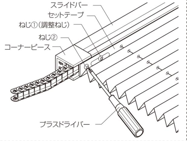
②セットテープをスライダ側から外します。セットテープとコーナーピースの下部の隙間にマイナスドライバーの先端を斜めから差し込み、持ち上げるとセットテープがスライダ側から外れます。外れた部分を持って下から引きはがすようにして上まで全部外します。
