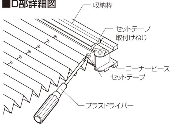
⑤ スライドバー側と同様に収納枠側のセットテープ・コネクタAを外してください。
