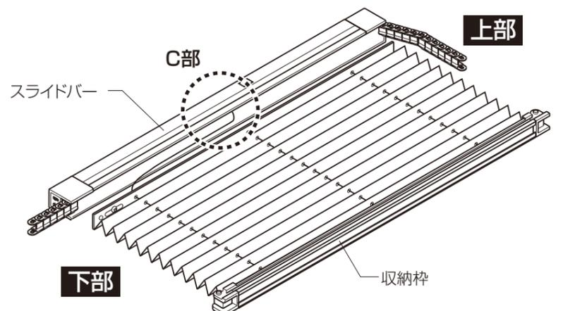
④ 収納枠側のセットテープ取付けねじを外します。
