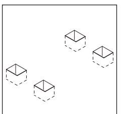
①柱の埋込み位置を出して、基礎穴を掘ってください。
