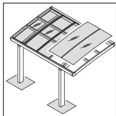
①屋根材を前枠のカバー部に差し込み、後枠の屋根材受けに差込んでください。
