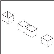
①柱の埋込み位置を出して、基礎穴を掘ってください。
