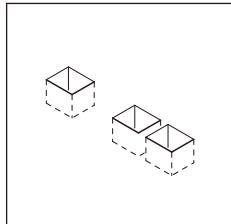
①柱の埋込み位置を出して、基礎穴を掘ってください。
