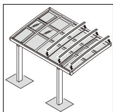
①垂木カバー・側枠カバーを、垂木・側枠に【7-2】で取付けてください。
