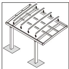
①垂木を後枠・母屋・前枠に【7-2】で取付けてください。
