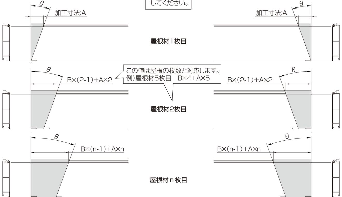
(3) 屋根材を斜めに切断加工してください。
