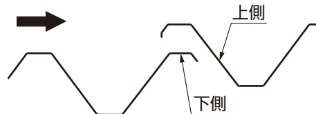
図4-6 折板重なり部詳細図
