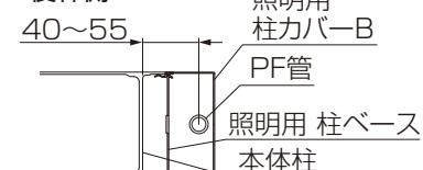
・前枠側/後枠側非排水の柱に照明を取り付ける場合は、柱取付照明部品セットの柱隙間ふさぎ部品(排水用)を取り付けてください。
