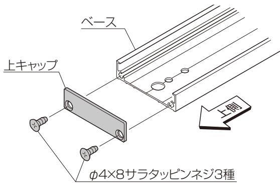
③本体柱カバーにベース、灯具取付金具、トランスカバー取付金具を【2-1】と【2-4】で取り付けてください。
