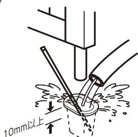
● 落し棒付の門扉では、落し棒の掛かりが10mm以下になる前に、落し棒受け内のゴミ・土・砂を取除いてください。落し棒の掛かりが浅いと、強風で扉が動き、扉の破損または人に当たるおそれがあります。
