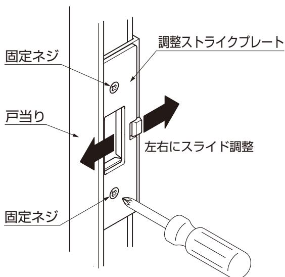
①調整ストライクの固定ネジをかるくゆるめ、調整ストライクプレートを左右にスライドして調整してください。
