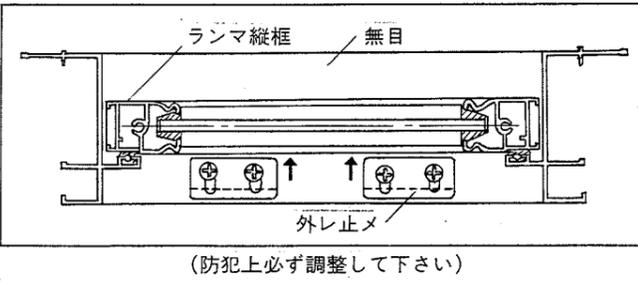
ランマを枠に嵌め込んだ際、無目上部両端の外れ止めを点線の位置まで矢印の方向に押し、ビスで締めて下さい。
