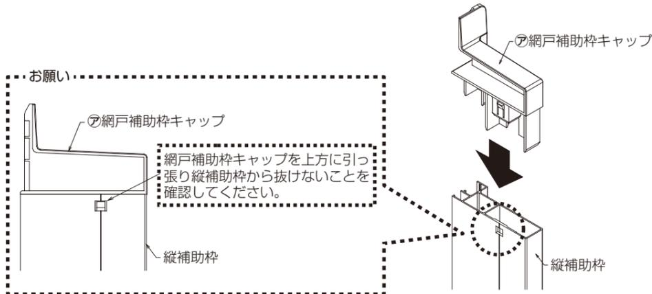
②縦補助枠を下枠とのすきまがないように端部位置合わせをして、補助枠アタッチメントの袖部側(リップの長い方)を基点に回転させるようにはめ込んでください。
