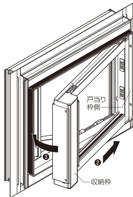
※浴室などの水のかかる場所でご使用の場合、取付けに使用したねじや、その並びに取付けられているねじに対して、必ずコーキング材でねじ穴周りをシーリング処理してください。水が躯体に周り漏水の原因になります。
