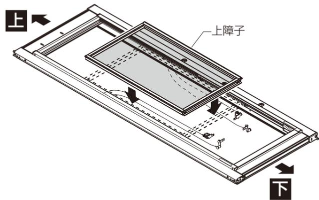
③上障子上棧に上障子上ガイドピース①を薄平小ねじ②でねじ止めしてください。
