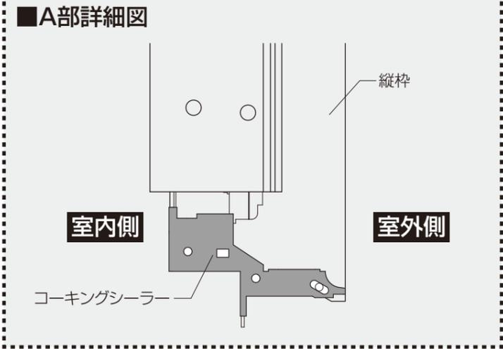
2 気密補助シールの取付け
